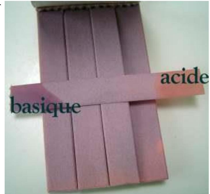
Attention : le papier tournesol réagit avec l'acidité de l'air due au gaz carbonique et devient rose à son contact. Il doit être conservé dans un emballage étanche (boîte, plastique,...).
