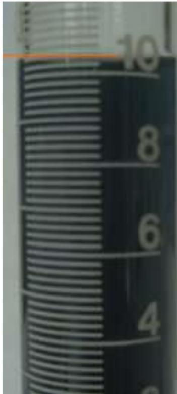
La lecture de l'acidité s'effectue en dessous du ménisque que forme le liquide avec les bords de l'éprouvette. Dans le cas de la mesure d'une acidité, le ménisque est bombé vers le bas et la lecture se fait par dessous.
